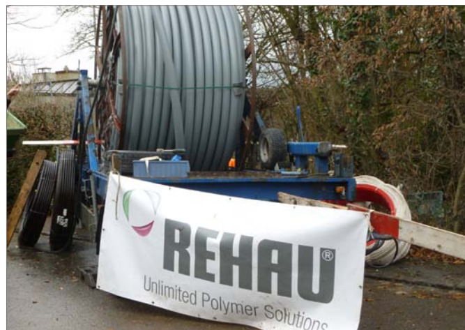
Trommelanhänger mit einer HPR Koaxial-Sonde à 450 m
