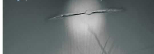
Fig. 2 Daño causado por una carga puntual en una sonda geotérmica de PE100 rota (vista sobre la cara interna del tubo, carga puntual desde el exterior)
