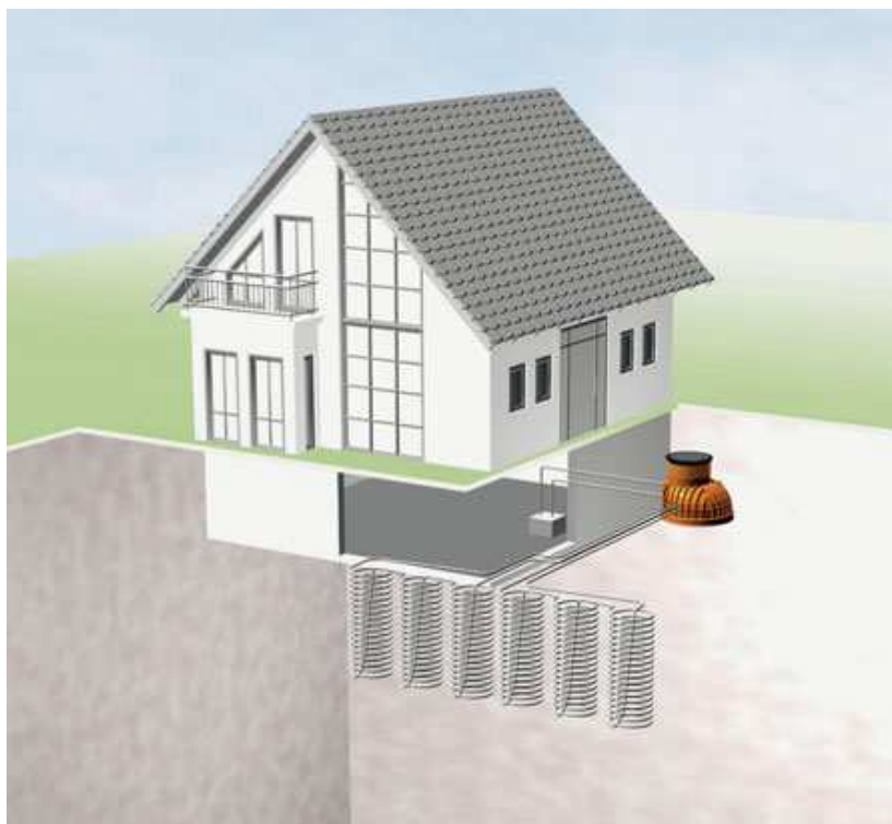
Fig. 8 Posición de montaje de las sondas helicoidales en PE-Xa
